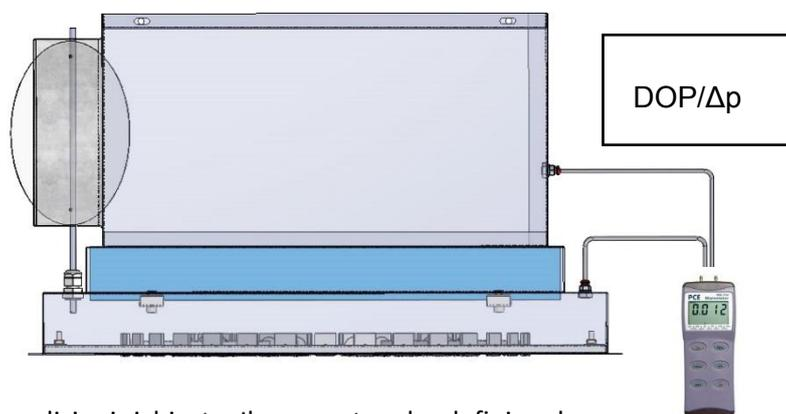
La frequenza necessaria va stabilita in base alle condizioni richieste. Il parametro che definisce la quantità di particelle di polvere presenti nel filtro è la pressione differenziale.
