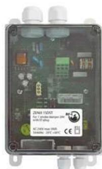
Il dispositivo da campo ZENiX 1SDST viene utilizzato per monitorare e controllare 1 serranda antifumo motorizzata con attuatore a 24 V con connettori ST. Non è richiesta alcuna configurazione poiché ha un indirizzo del dispositivo predefinito.
