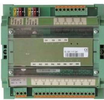
ZENiX DI8DO4 è un dispositivo da campo con 8 ingressi digitali senza potenziale e 4 uscite relè digitali. Può essere utilizzato per collegare ulteriori ingressi di allarme dall'incendio dal pannello di allarme (matrice), ad esempio. È possibile programmare le uscite relè e definire gli stati sicuri secondo necessità.
