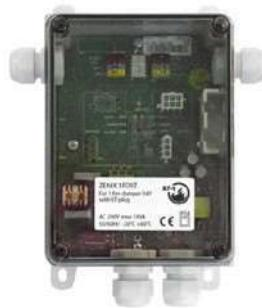
Il dispositivo da campo ZENiX 1FDST viene utilizzato per monitorare e controllare 1 serranda tagliafuoco motorizzata con attuatore a 24 V con spine di collegamento ST. Non è richiesta alcuna configurazione poiché ha un indirizzo del dispositivo predefinito.
