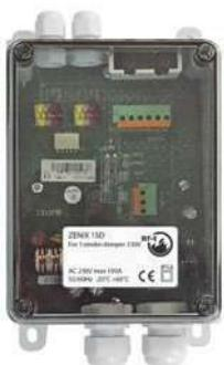
Il dispositivo da campo ZENiX 1SD viene utilizzato per monitorare e controllare 1 serranda tagliafumo motorizzata con attuatore a 230 V. Non è richiesta alcuna configurazione poiché ha un indirizzo del dispositivo predefinito.
