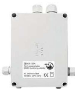
Il dispositivo da campo ZENiX 1SSH viene utilizzato per monitorare e controllare 1 serranda tagliafumo motorizzata 24 V. L'attuatore della tapparella viene azionato tramite 2 fili: l'inversione della polarità consente alla lama di muoversi nella direzione opposta. ZENiX 1SSH dispone di 4 ingressi digitali e 2 uscite relè.
