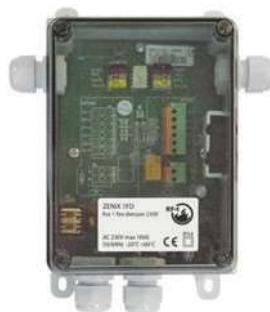
Il dispositivo da campo ZENiX 1FD viene utilizzato per monitorare e controllare 1 serranda tagliafuoco motorizzata con attuatore a 230 V. Non è richiesta alcuna configurazione poiché ha un indirizzo del dispositivo predefinito.
