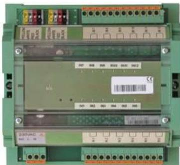
ZENiX DI12 è un dispositivo da campo con 12 ingressi digitali a potenziale zero. Può essere utilizzato per collegare ulteriori ingressi allarme dalla centrale di rivelazione incendio (matrice). Può essere utilizzato anche per collegare ingressi di campo come, ad esempio, finecorsa di serrande meccaniche.
