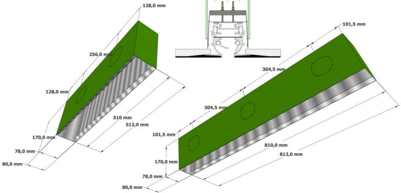
PLENUM EPLS 500 comprensivo di 2 manicotti tipo A Ø 63mm
